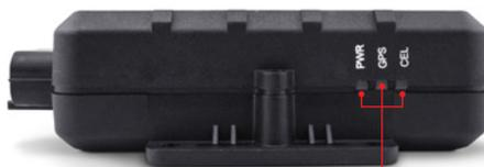
LED de encendido / LED de GPS / LED de Datos Móviles<sup>4</sup>
