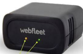
Två LED-lampor för system- och nätverksstatus
