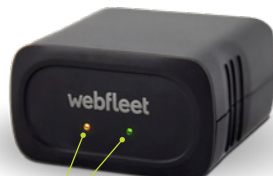
2 LED-statuslampjes voor de systeem- en verbindingstatus
