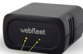
2 indicadores LED para mostrar el estado del sistema y la conexión
