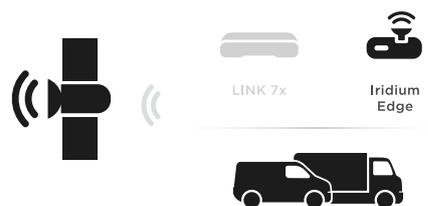
Más allá de las áreas de cobertura celular, Iridium Edge transmite la posición a WEBFLEET a través de la comunicación satelital<sup>3</sup>.
