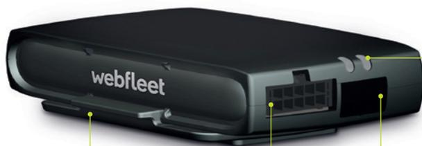
Adattatore di montaggio rimovibile (può essere montato su entrambi i lati del dispositivo)
