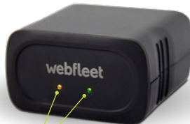
2 x LED per lo stato del sistema e della connessione
