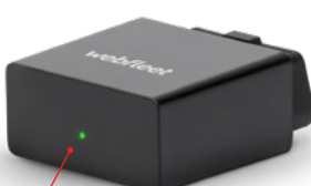
Dioda LED sygnalizująca stan połączenia
